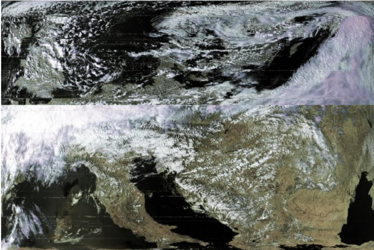
Die empfangenen Daten wurden per GNU Radio demoduliert und mit dem [HRPT Reader](#) dekodiert. Zu beachten gilt, dass die Ausgabedatei von GNU Radio auf `.raw16` enden muss, da die Datei sonst fehlinterpretiert wird.
