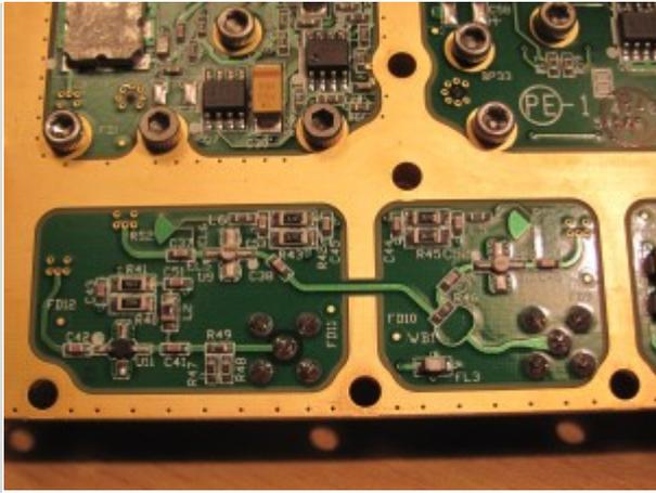
Das Empfangssignal landet auf der linken BMA-Buchse, für Isolation und breitbandige Anpassung sorgt ein MMIC-Verstärker gefolgt von einem Dämpfungsglied.
