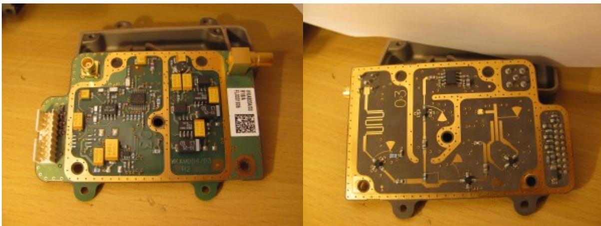
Der [Schaltplan](#) wurde rekonstruiert. Die Schleifenfilterbandbreite beträgt ca. 30 kHz bei einer angenommenen 1 MHz PFD-Frequenz.
