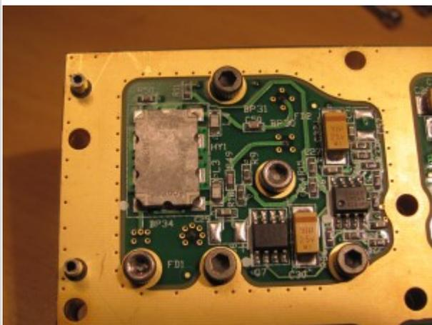
Die Ausgangssignale des Quadraturmischer wird mittels Hybrid-Koppler zusammengefasst und sorgt für Spiegelfrequenzunterdrückung. Rechts ist die Spannungsaufbereitung für den Mischer platziert.
