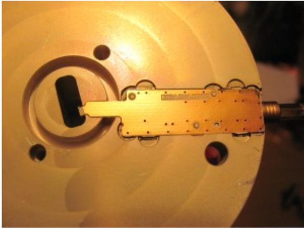
Es scheint, dass an der SMB-Buchse eine zur HF-Leistung proportionale Spannung zu messen ist. Leistungs-/Spannungskennlinie muss noch aufgenommen werden. Eine Anzeige der Ausgangsleistung am Transverter ist erstrebenswert.
