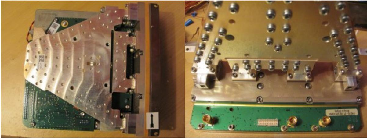
Die Baugruppen sind als kompakte Einheit miteinander verschraubt, ein Deckel bildet den Wetterschutz. Die ODU wird mittels einer Klemmhalterung am Hohlleiterflansch mit der Antenne verbunden.
