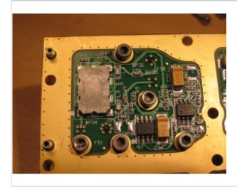
Die Ausgangssignale des Quadraturmischers wird mittels Hybrid-Koppler zusammengefasst und sorgt für Spiegelfrequenzunterdrückung. Rechts ist die Spannungsaufbereitung für den Mischer platziert.
