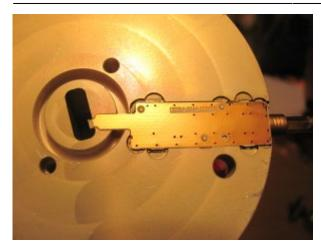
Es scheint, dass an der SMB-Buchse eine zur HF-Leistung proportionale Spannung zu messen ist. Leistungs-/Spannungskennlinie muss noch aufgenommen werden. Eine Anzeige der Ausgangsleistung am Transverter ist erstrebenswert.
