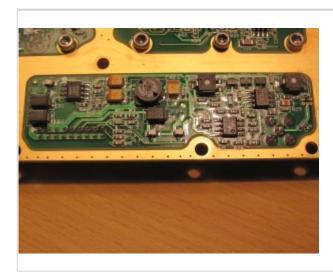
Die Stiftleiste verbindet diese Baugruppe mit dem Spannungsversorgungs-Modul. Es werden 2 positive und eine negative Spannung benötigt. Die übrigen Pins könnten Steuerleitungen vom Controller oder analoge I/Os sein.
