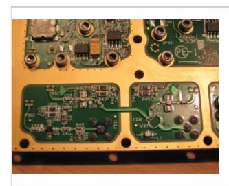
Das Empfangssignal landet auf der linken BMA-Buchse, für Isolation und breitbandige Anpassung sorgt ein MMIC-Verstärker gefolgt von einem Dämpfungsglied.
