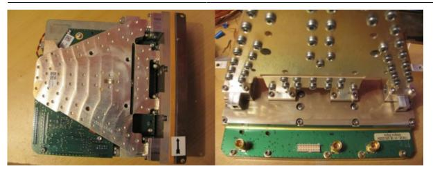
Die Baugruppen sind als kompakte Einheit miteinander verschraubt, ein Deckel bildet den Wetterschutz. Die ODU wird mittels einer Klemmhalterung am Hohlleiterflansch mit der Antenne verbunden.
