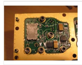
Die Ausgangssignale des Quadraturmischers werden mittels Hybrid-Koppler zusammengefasst, dieser sorgt für Spiegelfrequenzunterdrückung. Rechts ist die Spannungsaufbereitung für den Mischer platziert.
