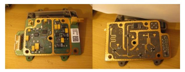
Der Schaltplan wurde rekonstruiert. Die Schleifenfilterbandbreite beträgt ca. 30 kHz bei einer angenommenen 1 MHz PFD-Frequenz.
