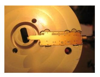
Es scheint, dass an der SMB-Buchse eine zur HF-Leistung proportionale Spannung zu messen ist. Leistungs-/Spannungskennlinie muss noch aufgenommen werden. Eine Anzeige der Ausgangsleistung am Transverter ist erstrebenswert. From:
