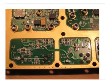
Das Empfangssignal landet auf der linken BMA-Buchse, für Isolation und breitbandige Anpassung sorgt ein MMIC-Verstärker gefolgt von einem Dämpfungsglied.
