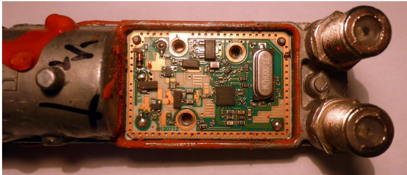
Für Horizontale und Vertikale Polarisation gibt es je ein Frontend bestehend aus einem LNA und einem Verstärker, ein Splitter teilt das verstärkte Signal auf die beiden Downconverter auf. Diese besitzen jeweils einen weiteren Verstärker pro Polarisation, dessen Spannungsversorgungen selektiv aktiviert werden. Ein Combiner wird jeweils verwendet um die beiden Verstärkerausgänge zu addieren, danach erreicht das Signal den RDA3565ES.
