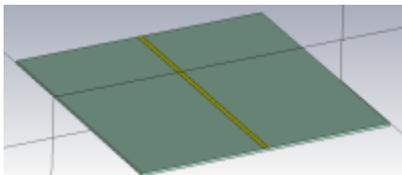
Die Geometriedefinition erfolgte wieder parametrierbar, die Maße für die Leiterbahn auf der Oberfläche wurde aus den gegebenen Werten (Kupferschichtdicke, Substratdicke, rel. Permittivität von FR-4) mit AppCAD ermittelt.
