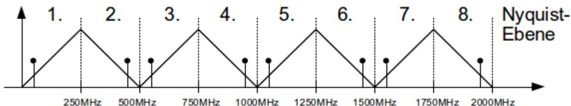
Optimal ist eine Samplerate von 340Mps. Dadurch liegt die Mitte der 8. Nyquist-Ebene in der Bandmitte und es sind rund 60MHz Abstand zwischen den Bandgrenzen und der nächst niedrigeren bzw. höheren Nyquist-Ebene. Der Empfangsbereich erstreckt sich dann von 1190 - 1360 MHz. Dies ist interessant für die Dimensionierung des Bandpasses vor dem ADC. Da Signale unter 1140MHz in das Nutzband gespiegelt werden, muss der Bandpass dort hinreichend stark dämpfen. Analog auch für Signale über 1420MHz.
