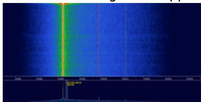
Der Dynamikbereich(SNR bei 1Hz BW) liegt bei ca. 110dB, das Spektrum bei Ansteuerung mit -95dBm:
