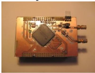
Rechts sind die Koax-Buchsen für den Antennenanschluss und den Takteingang zu sehen. Eine 3er Pinleiste ist für S/PDIF vorgesehen.
