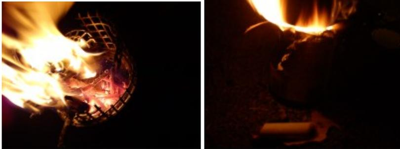
Testkochen mit Lüftersteuerung Topfständer und fixierter Bodendose. Die Fenster im Topfständer sind zum nachlegen recht praktisch und mit der Lüftersteuerung kann man in etwa den Kocher regulieren.
