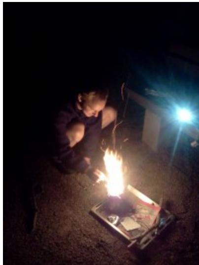
Der Prototyp besteht aus 2 Dosen die ineinander gesteckt sind. Über die äußere Dose entsteht die Luftzufuhr für die innere Dose. In der inneren Dose wird dann Luft und Gas(das beim Holzverbrennen entsteht) gemischt. Die Luftzufuhr entsteht über einen externen Lüfter.
