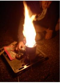
Der Prototyp besteht aus 2 Dosen die ineinander gesteckt sind. Über die äußere Dose entsteht die Luftzufuhr für die innere Dose. In der inneren Dose wird dann Luft und Gas(das beim Holzverbrennen ensteht) gemischt. Die Luftzufuhr entsteht über einen externen Lüfter.
