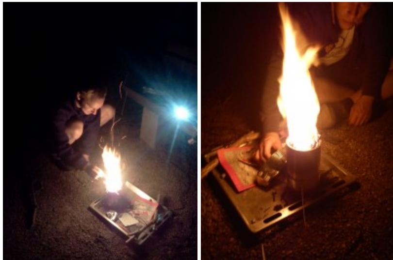
Der Prototyp besteht aus 2 Dosen die ineinander gesteckt sind. Über die äußere Dose entsteht die Luftzufuhr für die innere Dose. In der inneren Dose wird dann Luft und Gas(das beim Holzverbrennen entsteht) gemischt. Die Luftzufuhr entsteht über einen externen Lüfter.
