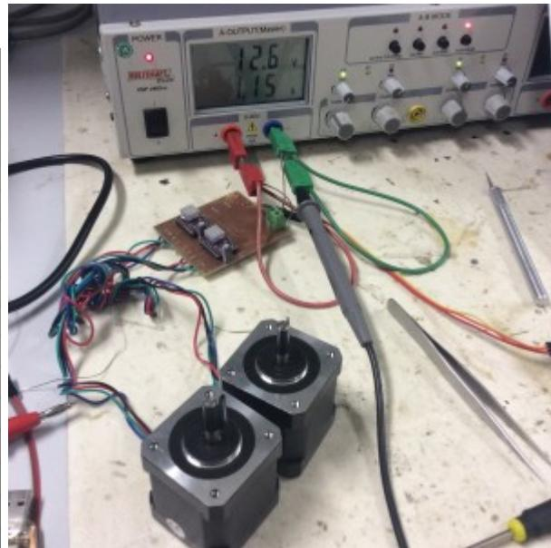
Die original SatNOGS-Elektronik verwendet einen Arduino Micro und Schrittmotortreiber von Polulu (Breakout-Board für A4988). Die Arduino-Software geht auch auf einem Standard-AtMega, als Ersatz für das Breakoutboard werden Boards mit DRV8825 benutzt.
