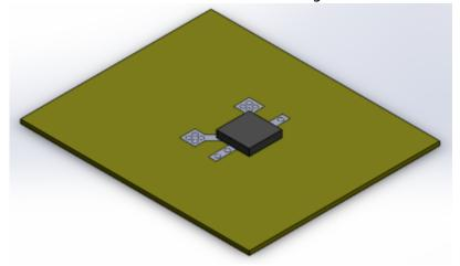
Das Modell wurde mit Konvektion von allen Flächen (8 W/m² K) zur 22°C warmen Luft und interner Wärmeerzeugung des Schaltkreises (0,0541W/mm^3) ausgestattet. Als Solver wurde eine thermischstationäre Analyse gewählt, um den eingeschwungenen Zustand des Systems analysieren zu können.
