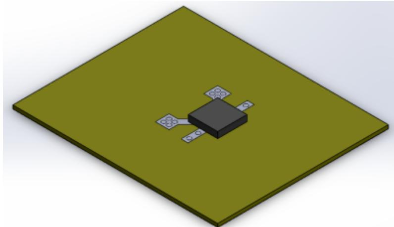
Das Modell wurde mit Konvektion von allen Flächen ( $8 \text{ W/m}^2 \text{ K}$ ) zur  $22^\circ\text{C}$  warmen Luft und interner Wärmeerzeugung des Schaltkreises ( $0,0541\text{W/mm}^3$ ) ausgestattet. Als Solver wurde eine thermisch-stationäre Analyse gewählt, um den eingeschwungenen Zustand des Systems analysieren zu können.
