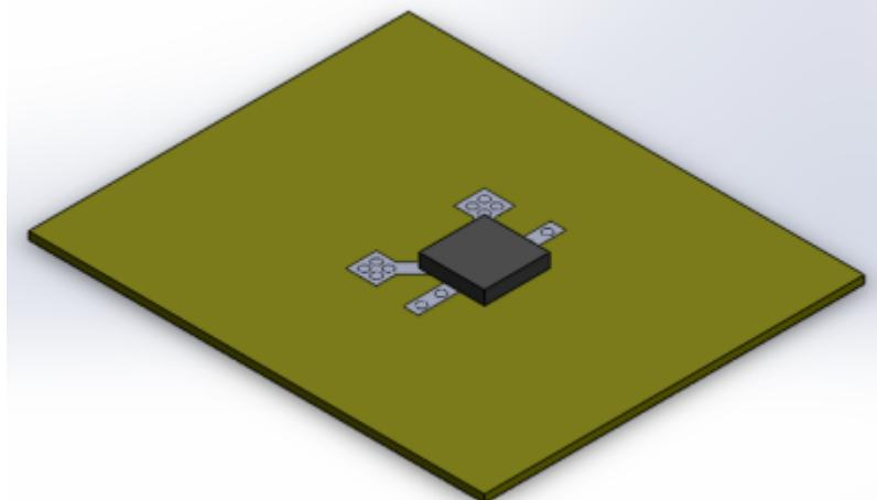
Das Modell wurde mit Konvektion von allen Flächen (8 W/m<sup>2</sup> K) zur 22°C warmen Luft und interner Wärmeerzeugung des Schaltkreises (0,0541W/mm<sup>3</sup>) ausgestattet. Als Solver wurde eine thermisch-stationäre Analyse gewählt, um den eingeschwungenen Zustand des Systems analysieren zu können.
