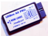
wurden drei USBee AX PRO clone von [DX](#) geordert. (zu ca. 10 € pro Stück) Dieser soll mit der Software von [USBee](#) zusammen arbeiten, da die aber nicht unter Linux läuft und auch sigrok den so nicht akzeptieren möchte, wurde der Inhalt der eeproms angepasst.
