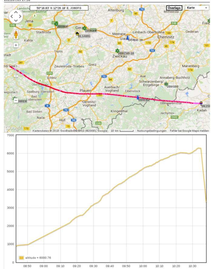
APRS als Übertragung hat sich auf jeden Fall bewährt und wurde weit aufgenommen (>180km), dies wird bei künftigen Flügen wohl als Hauptverfolgsungsbetriebsart eingesetzt! Der vertikale 2m-Dipol lässt sich auch mechanisch gut realisieren.
