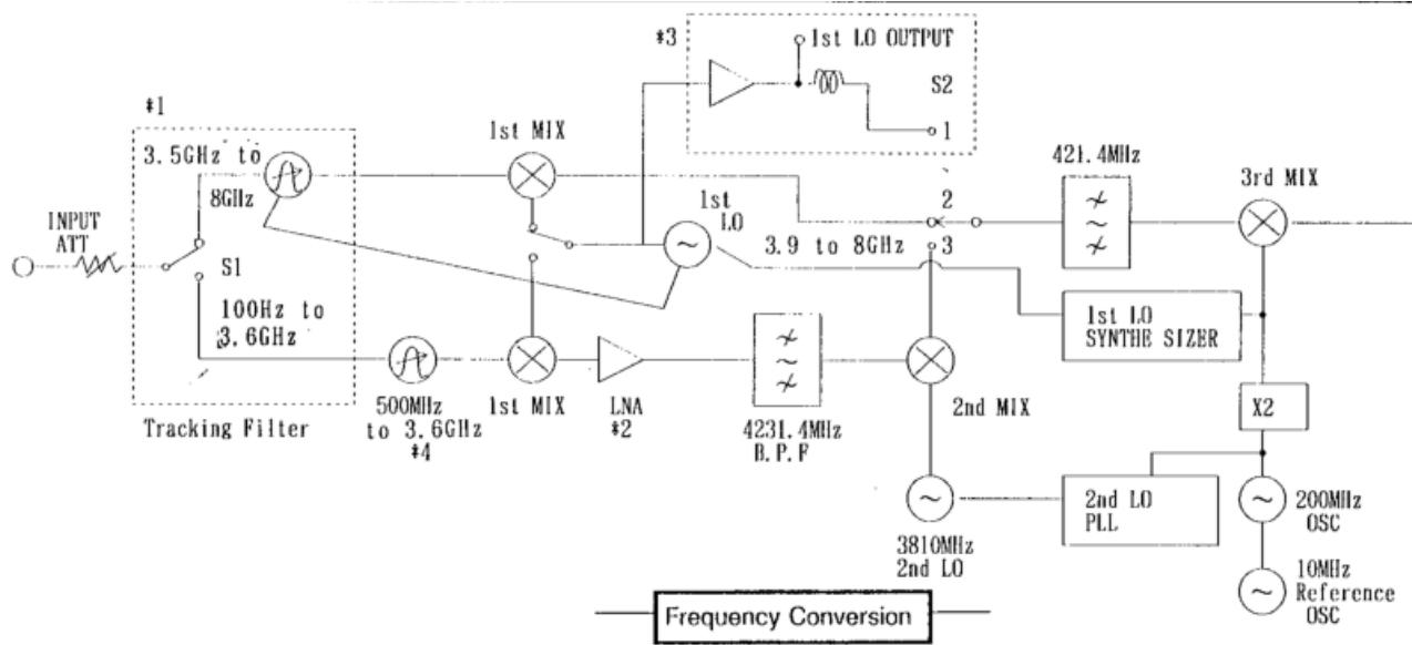
Der Spektrumanalysator Typ R3265 ist gleich aufgebaut, ihm fehlt nur das High-Band.
