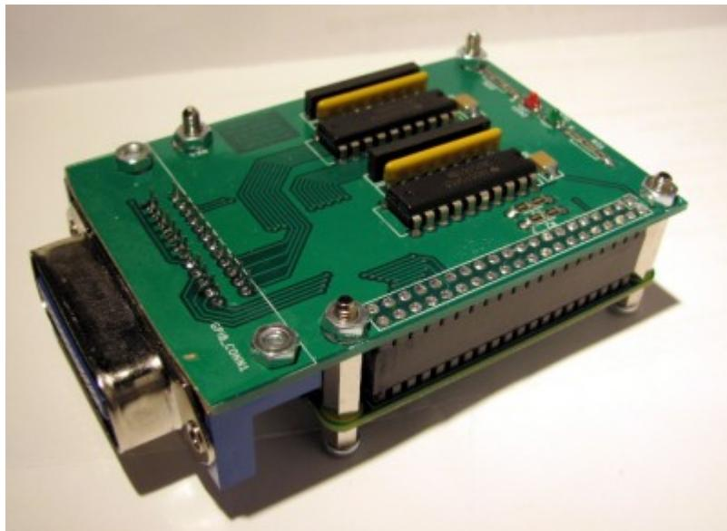
Das Bild zeigt ein Sandwich aus GPIB Shield und Raspberry Pi Zero.
