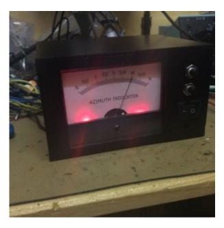
Die Elektronik beschränkt sich auf eine OPV-Schaltung, die als Impedanzwandler für das Poti und Subtrahierer einer einstellbaren Spannung wirkt. Damit kann der Offset vom 10Gang-Potentiometer-Spannungsteiler wegkalibriert werden. Die Endwertkalibrierung erfolgt über einen Serienwiderstand zum Zeigerinstrument.
