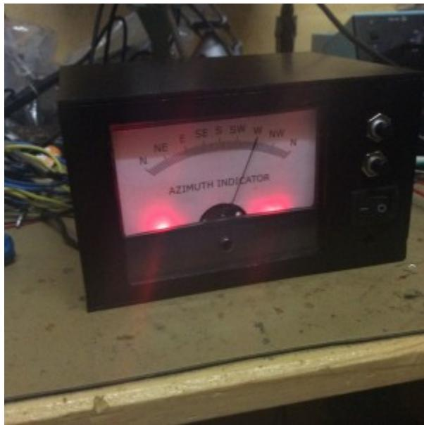
Die Elektronik beschränkt sich auf eine OPV-Schaltung, die als Impedanzwandler für das Poti und Subtrahierer einer einstellbaren Spannung wirkt. Damit kann der Offset vom 10Gang-Potentiometer-Spannungsteiler weggalibriert werden. Die Endwertkalibrierung erfolgt über einen Serienwiderstand zum Zeigerinstrument. Ein Problem des Steuergerätes ist die Nichtlinearität des verwendeten Zeigerinstruments - ein Instrument mit Genauigkeitsklasse 1% oder besser sollte hier Verwendung finden.
