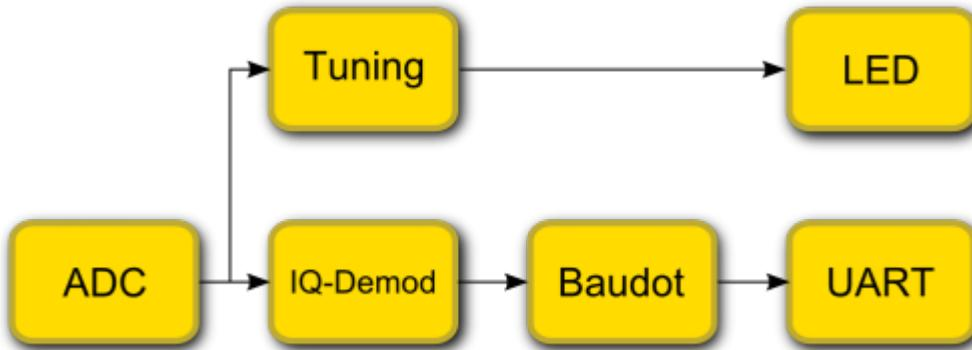
Ausgegangen wird im Folgenden von der direkten Abtastung der NF eines FuG. Das NF-Signal vom FuG wird Tiefpassgefiltert und vom ADC abgetastet. Es wird intern dem FSK-Demodulator zugeführt, aus welchem die demodulierten, digitalen Daten herauskommen. Die Baudot-Erkennung wandelt die digitalen Daten des Demodulators in ASCII-Zeichen. Die Ausgabe dieser erfolgt per UART und (optional) auf einem kleinen Display (HD44780?).
