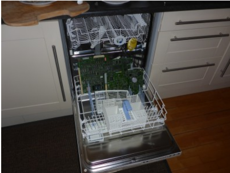
Leiterplattenreinigung in der Spülmaschine
