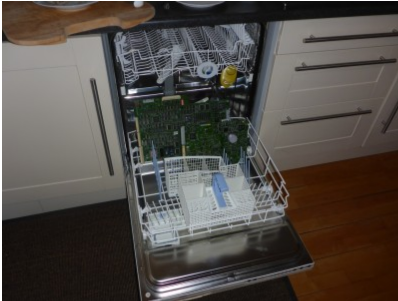
Leiterplattenreinigung in der Spülmaschine
