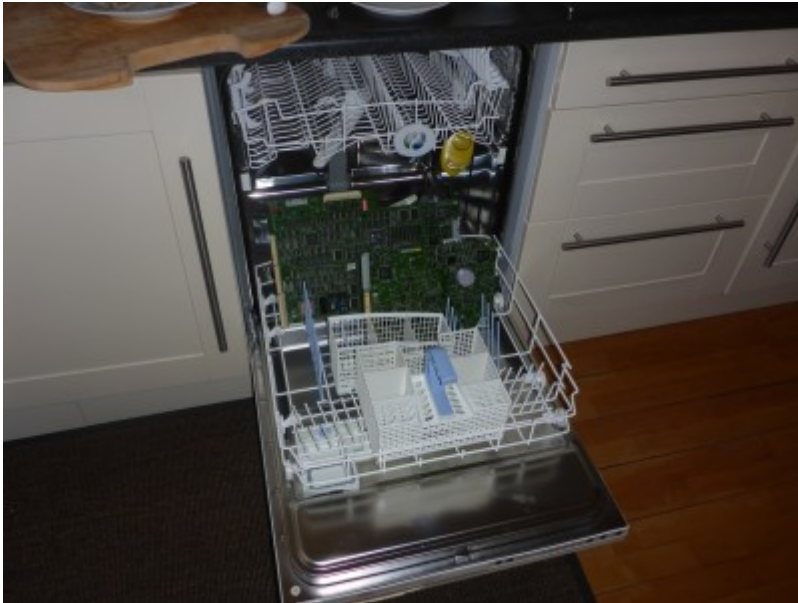
Leiterplattenreinigung in der Spülmaschine
