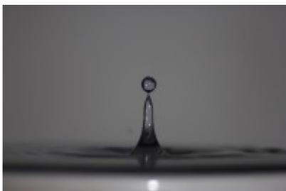
Als Zusatzaufgabe wurde das Magnetventil nach der ersten Öffnung in einem Abstand von etwa 20 ms ein weiteres mal geöffnet. So lösten sich zwei Tropfen ab, deren Kollision nach dem Austreten aus der Oberfläche festgehalten werden konnten.
