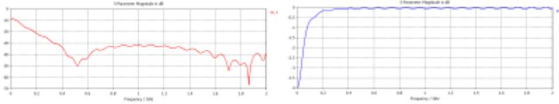
Wie zu erwarten war, ist die Dämpfung im Bereich kleiner Frequenzen sehr groß, bleibt aber dann über einen weiten Frequenzbereich bis über 2GHz sehr klein ( $<0.1\text{dB}$ ). Reflexionen treten kaum auf, die Anpassung an 50 Ohm ist also durchaus gegeben. Es ließen sich durch Verändern der Geometrie schnell deutlich schlechtere Ergebnisse erzielen.
