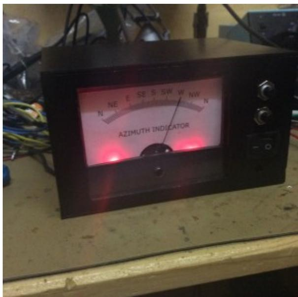
Die Elektronik beschränkt sich auf eine OPV-Schaltung, die als Impedanzwandler für das Poti und Subtrahierer einer einstellbaren Spannung wirkt. Damit kann der Offset vom 10Gang-Potentiometer-Spannungsteiler wegkalibriert werden. Die Endwertkalibrierung erfolgt über einen Serienwiderstand zum Zeigerinstrument. Ein Problem des Steuergerätes ist die Nichtlinearität des verwendeten Zeigerinstruments - ein Instrument mit Genauigkeitsklasse 1% oder besser sollte hier Verwendung finden.
